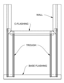
JOGGLES ON THE WATER TROUGH AND C-FLASHING SHOULD LINE UP
